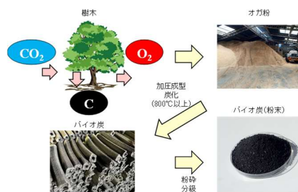
図-3 使用したバイオ炭の製造フロー
