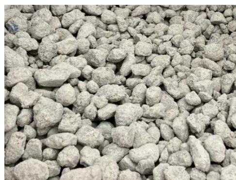
写真1 粒状化再生粗骨材（GRG）
