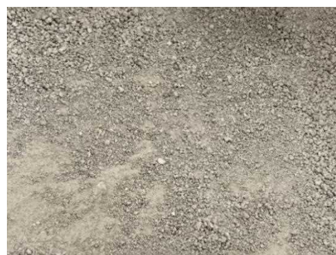
写真2 粒状化再生細骨材（GRS）
