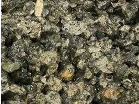
写真 1 曲げ強度試験後の破断面
