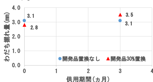
図-4 わだち掘れ量の経時変化
