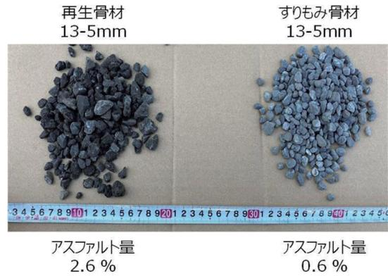
写真-3 再生骨材とすりもみ骨材の外観
