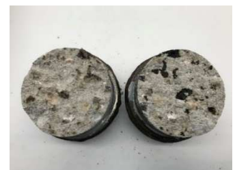
写真-4 破断面 (引張接着試験)
