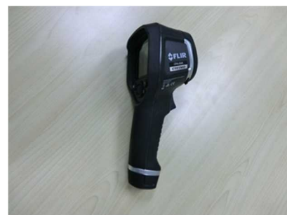
写真-1 サーモグラフィ
