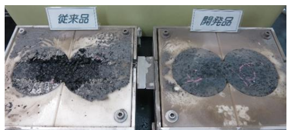
写真-2 HWT試験後の供試体
