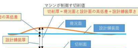
図-5 MC で制御する切削値の概念
