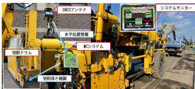
写真-1 GNSS による切削機 MC 例
