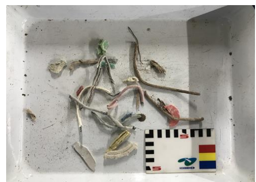
写真1 骨材 36t から取り出した混入物
