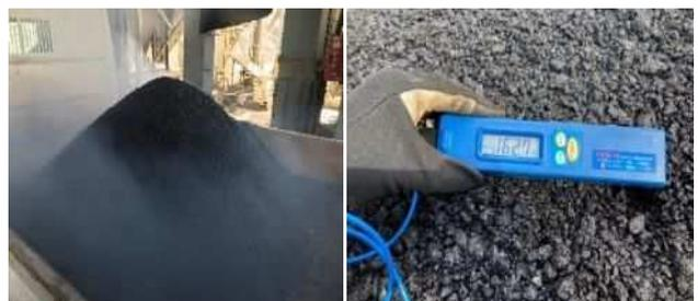
写真-3 Pen90を用いた混合物の練り落とし時の状態
