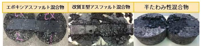
写真-1 HWT試験後供試体
