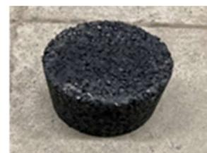
写真-1 浸漬状況と脱型直後の供試体
