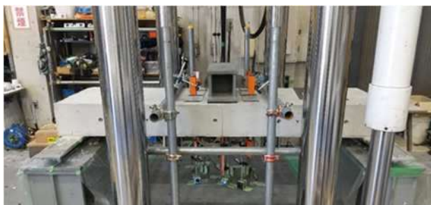
写真 2 大型供試体を用いた曲げ載荷試験
