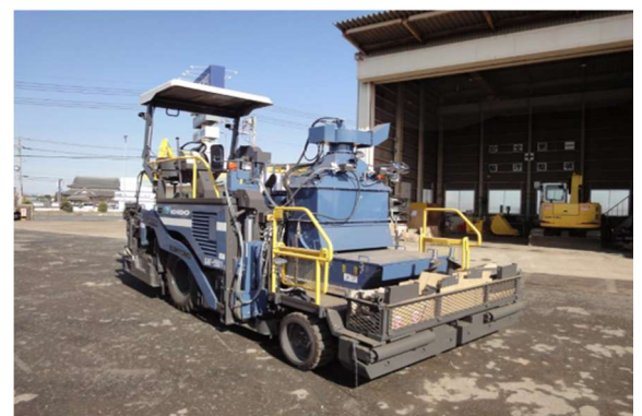
写真-4 開発したアスファルトベンチレーションシステム
