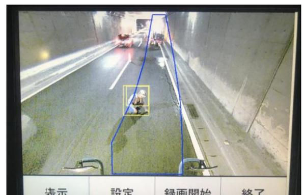
写真-4 夜間修繕舗装工事の検知状況
