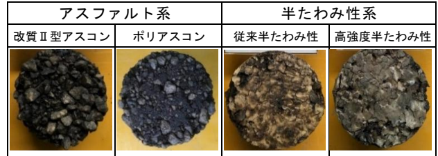
写真-3 耐油性試験後の供試体
