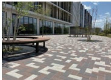
超微多孔質セラミック基盤の破砕材を用いたインターロッキングブロックです。従来の保水ブロックに比べ保水力を大幅に向上させています。
