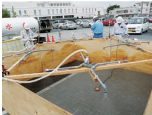
人工降雨装置による雨水浸透貯留試験 時間あたり60～100mmの降水量で実験 2015年10月1日 熊谷市役所駐車場
