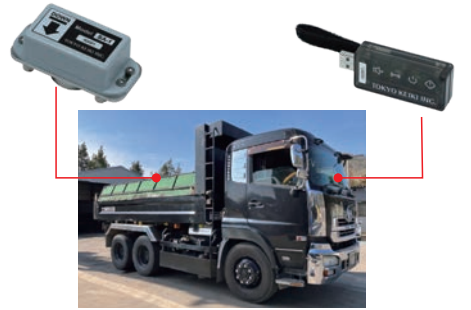
センサーをあおりシートに、警報器を運転席に設置し、あおりシートが開いているときに警告音で知らせる仕組み
