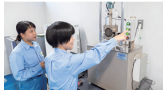
供試体を圧縮して強度を測る「マーシャル安定度試験」の様子
