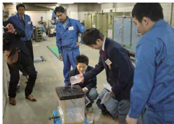
実験室での排水性舗装の実験
