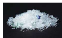
使用済みPETボトルをフレーク状に細断
