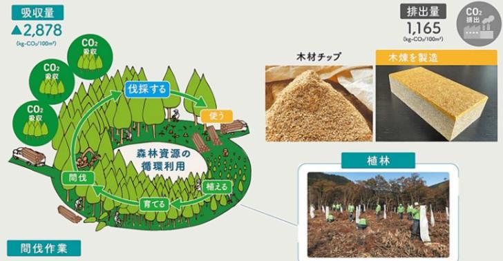
木煉は、100m<sup>2</sup>分を製造する際に二酸化炭素を1,165kg排出しますが、原材料である木質チップ材が2,878kgの二酸化炭素を吸収しているため、排出量よりも吸収量が上回り、**カーボンネガティブ**な舗装材と言えます。工場などで削減しきれない排出量をオフセットすることができる**ネガティブエミッション技術**、それが「木煉」です。
