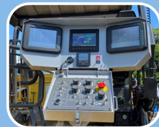
初期設定や走行位置の自動・手動の切替はアスファルトフィニッシャに取り付けたモニターで簡単に操作が行えます。
