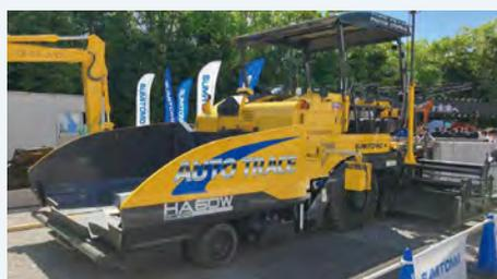
自動化によりオペレータの作業負担が大幅に軽減され、経験の浅いオペレータでも安全と品質に意識を向けた質の高い施工が可能となります。また、一般的なICT施工のように設計データを入力する必要がないため、より手軽に扱うことができます。
